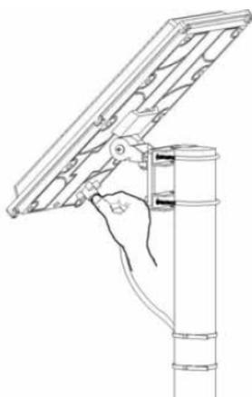
5. Regolare l'azimuth e l'angolo di elevazione dell'antenna in accordo a luogo in cui ci si trova (i dettagli verranno forniti all'interno della guida d'installazione dell'antenna), in modo da avere la migliore qualità del segnale indicata sul display del terminale Thuraya.
